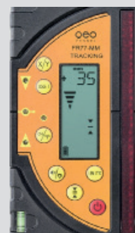
Laserstrålen rammer modtageren 35 mm under nulmarkeringen (før modtageren nedad).
