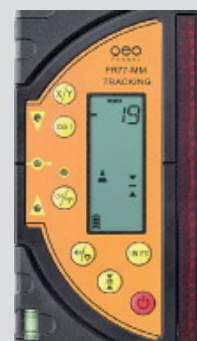
Laserstrålen rammer modtageren 19 mm over nulmarkeringen (før modtageren opad).
