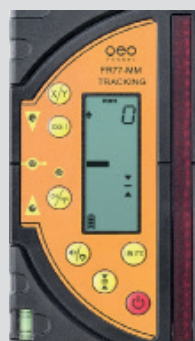
Laserstrålen rammer nulmarkeringen på modtageren præcist.
